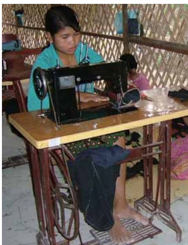
いぐさ製品をつくるためのミシン。 電気がないため、足踏み式です
